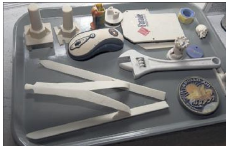
3D-print kan produsere «kva som helst» tredimensjonalt, slik som for eksempel ein skiftenøkkel med rørlege delar.
